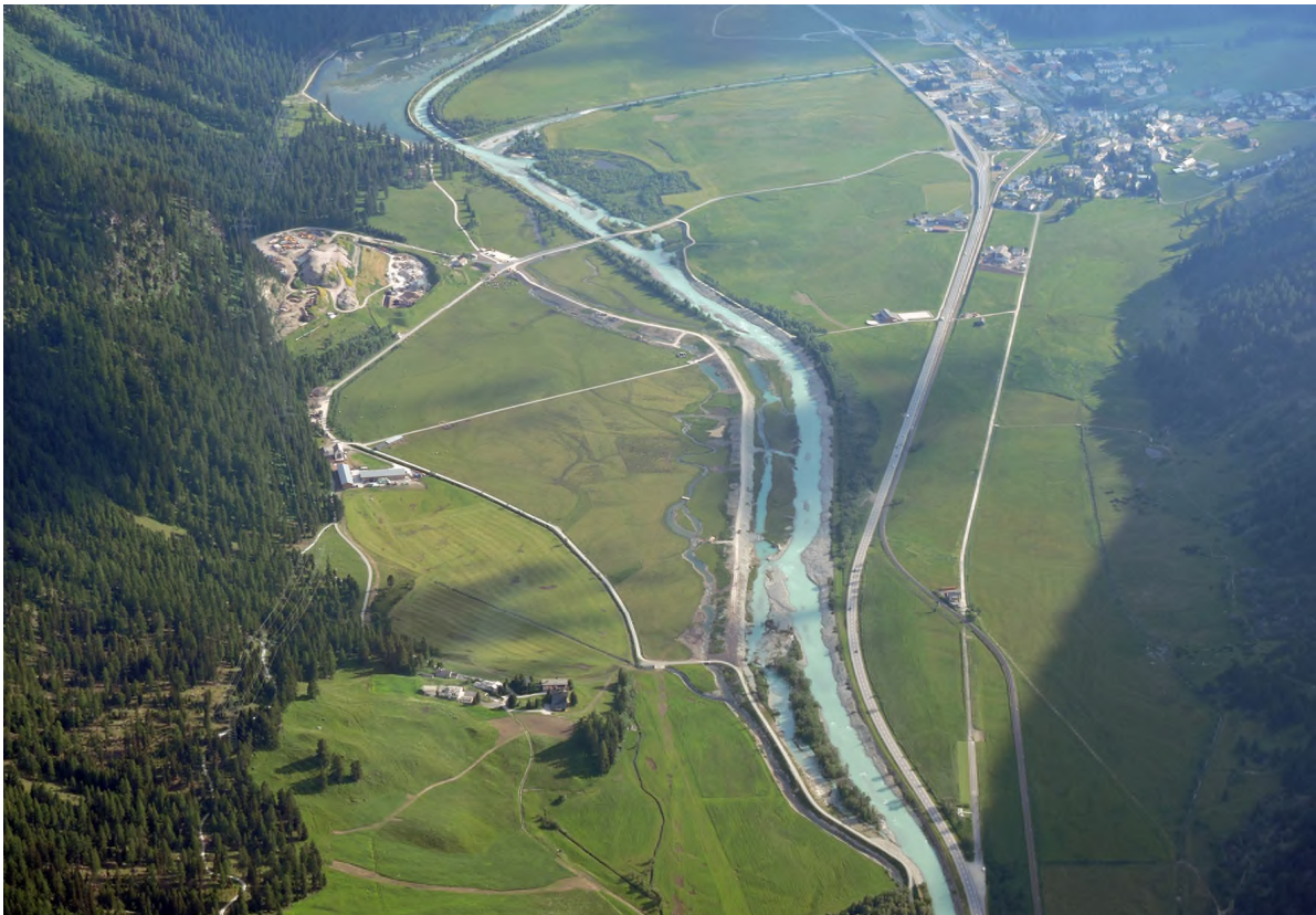
Der Inn im Überblick: am unteren Bildrand endet die 2. Etappe der Revitalisierung, bei der Isellasbrücke schliesst die 1. Etappe nahtlos an und oberhalb der Einmündung des Beverins, gegen den oberen Bildrand, ist der Inn noch zwischen seinen alten Dämmen eingezwängt (Foto: 25. Juni 2020).
